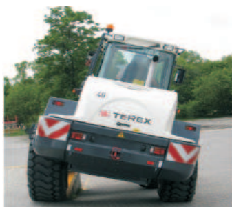
Axa spate oscilanta \pm 12^\circ ofera stabilitate si contact cu solul excelente
