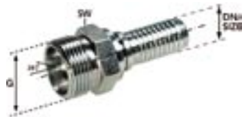
Außengewinde, leichte Reihe, Bohrungsform W 24°, Form D, E DIN ISO 12151-2, Reihe L Male Nipple with 24°, light series (L)
