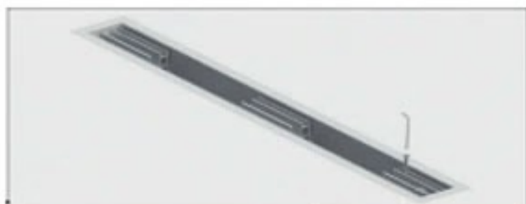
4. Desenare de poziționare a profilelor pentru parapet. Găurirea găurilor pentru dibluri și montarea profilelor.
