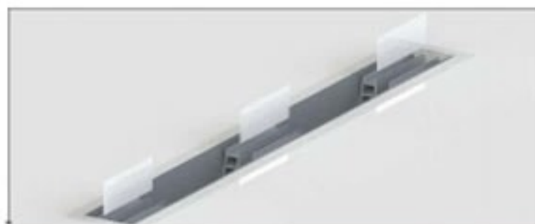
5. Instalarea suportul de plastic între profil și sticlă.
